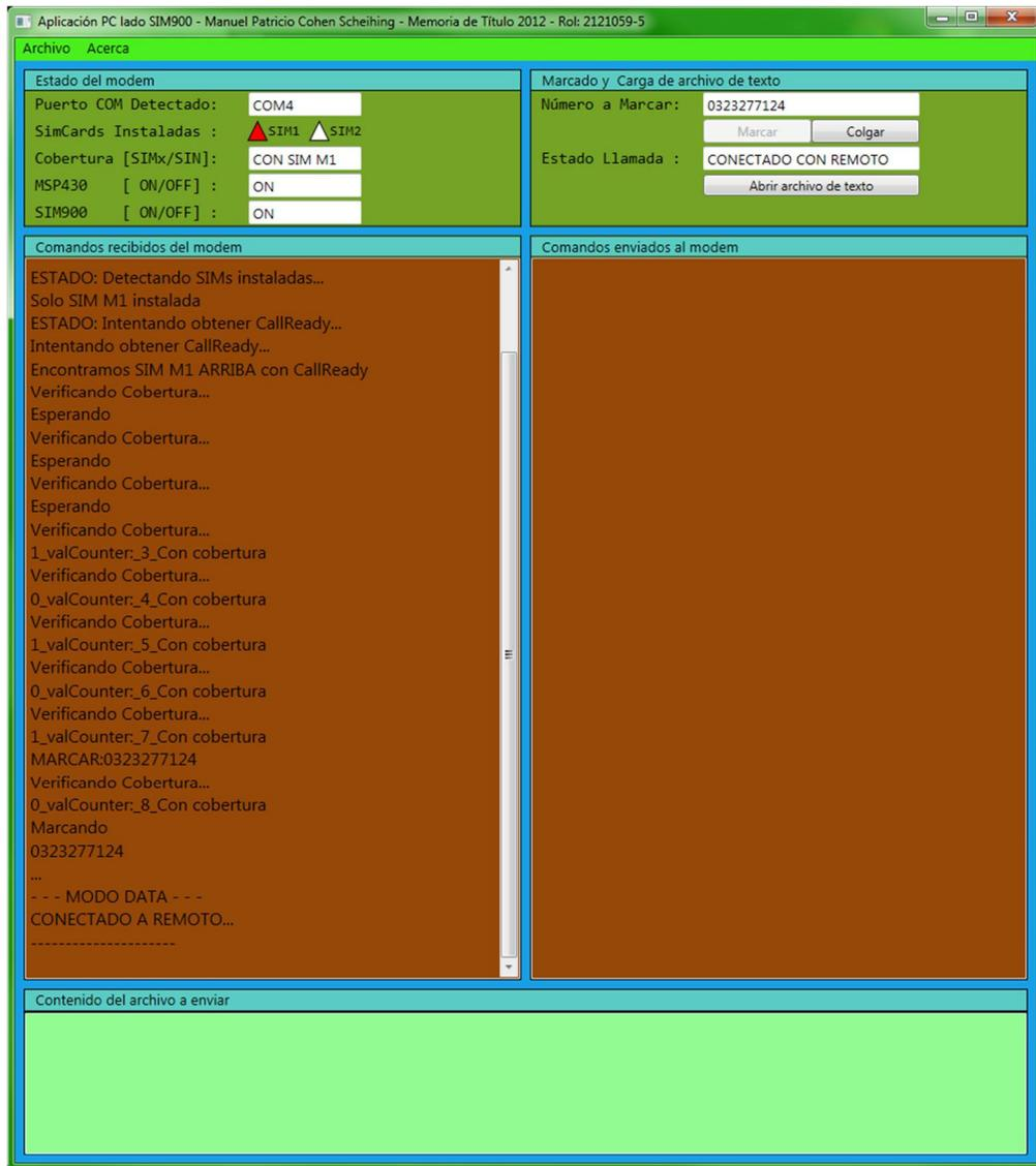
Fig. 5.6. Vista de la aplicación lado cliente para cuando se tiene una conexión de datos activa con el servidor
