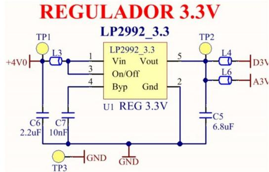
Fig. 2.12. Regulador lineal de 3.3[V]
