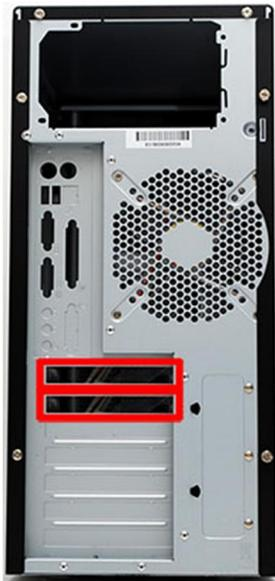
Fig. 1.7. Vista posterior de un gabinete de computador donde se muestra en destacado en rojo la zona donde las tarjetas SIMs de ambos módems estarían expuestas
